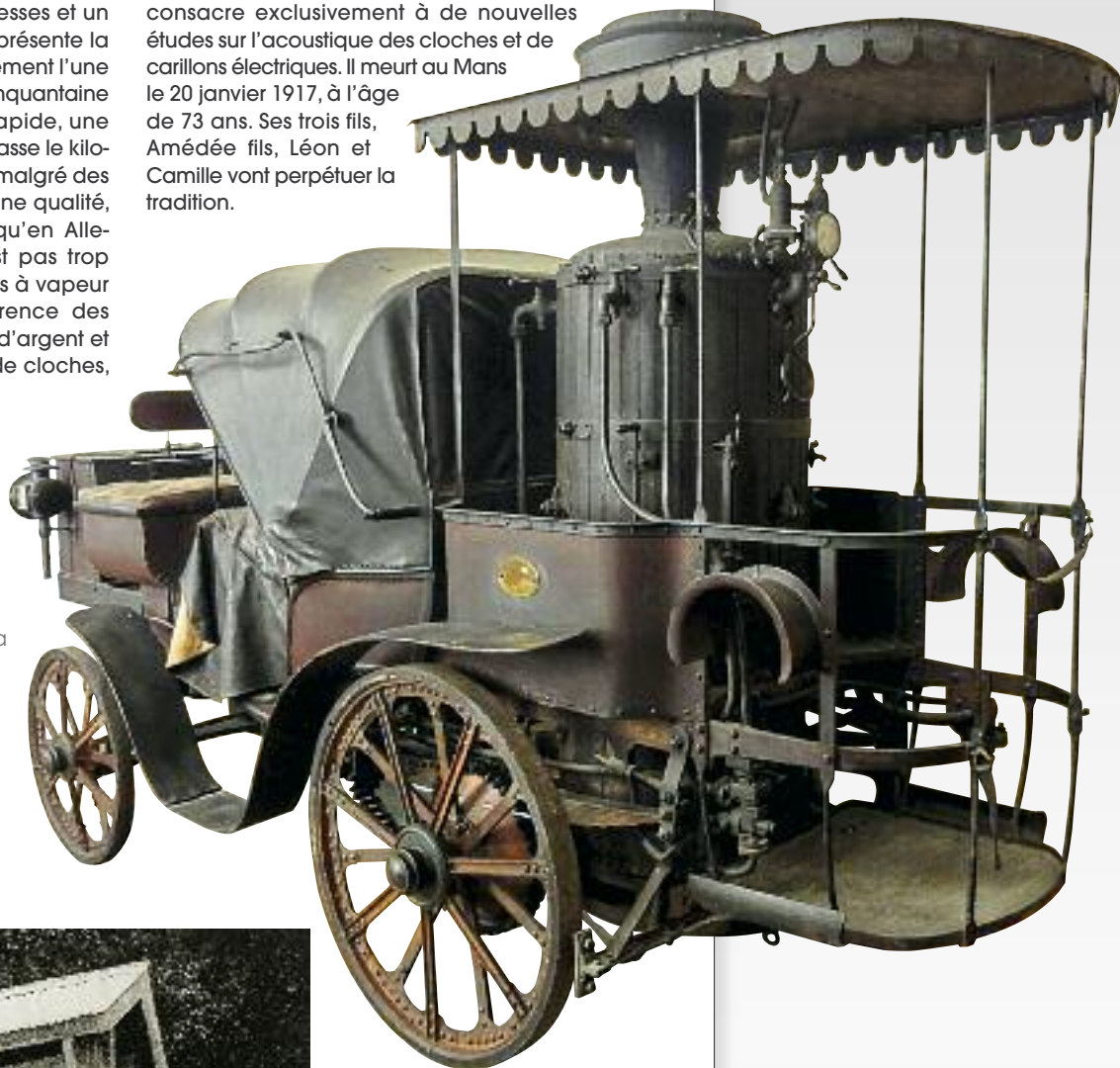
La Mancelle, conçue en 1878 par Amédée Bollée père, est la première voiture fabriquée en série (environ 50 exemplaires).
