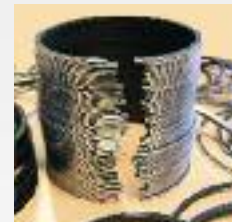
Segments Bollée qui assurent l'étanchéité du piston dans le cylindre du moteur.
