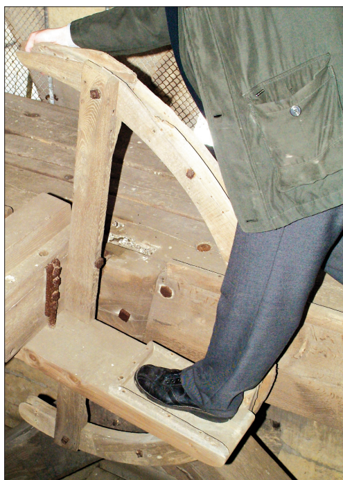
Mécanisme de mise en branle par pédalier.
