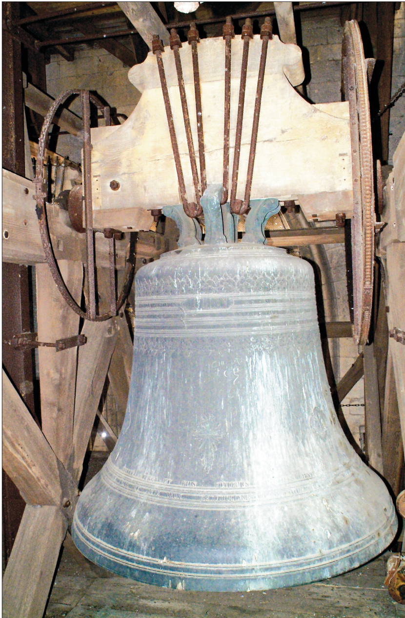
Julien : hauteur à l'axe : 192 cm, diamètre ext. : 218 cm, épaisseur : 15,5 cm, poids : 6423 kg, note : Fa dièse 2.
