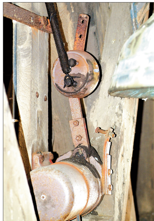
Mécanisme de tintement à l'aide d'un marteau.
