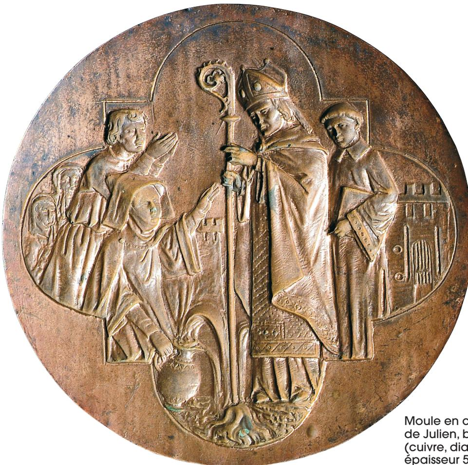
Moule en creux utilisé pour le décor de Julien, bourdon de la cathédrale du Mans. (cuivre, diamètre: 161 mm, épaisseur 5 mm, col. Bollée)
