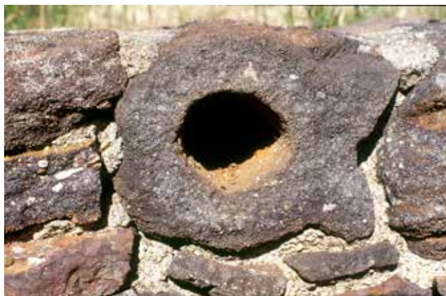
Figure 200 - Concrétion tubulaire de grès roussard, intégrée dans une construction, résultant de la cimentation du sable entourant des racines de végétaux.
